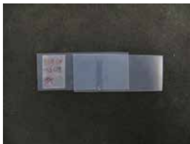
PFA1.0mm厚シート溶着のサンプル外観
